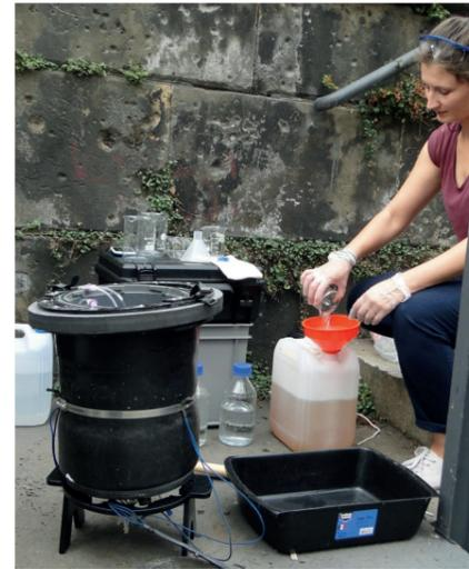
Bild 4a+b Echtzeit-Überwachung von Hygieneparametern in Badegewässern mit dem Sensor ALERT der Firma Fluidion: Vorbereitung und Fernüberwachung des Sensors zur Messung von E. coli und Enterokokken beim Einsatz in der Berliner Stadtspre. Quelle: KWB
